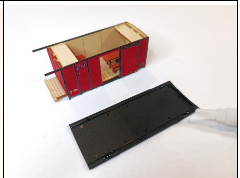
Das Dach mit vier Tropfen Kleber fixieren und in Hand kurz antrocknen.
