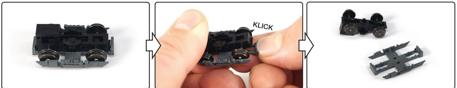
**Schritt 3: Blende am Antrieb anbringen**
