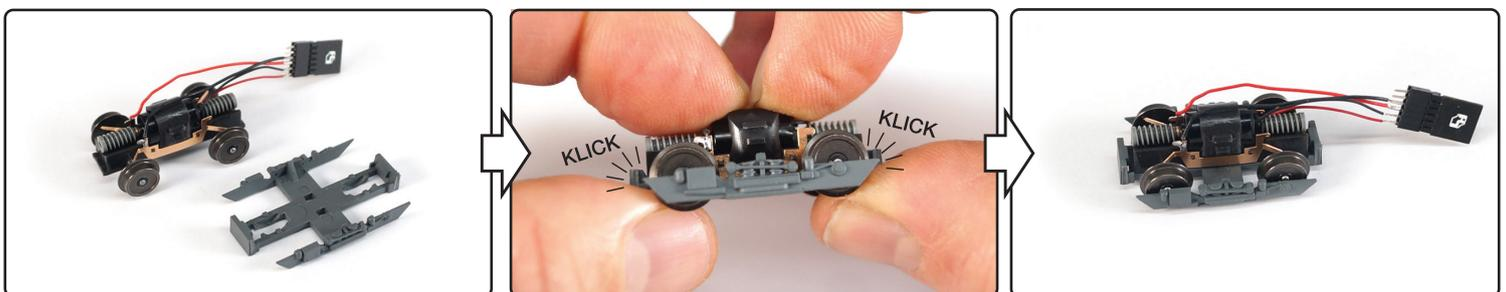
**Schritt 4: Antrieb einbauen**
