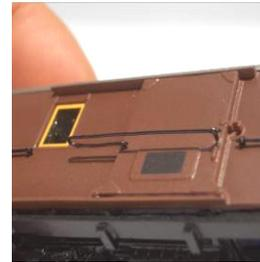
Die gebogene Railing (EHE1007) wird an beiden Seiten des Wagens an der Tür in die vorgesehenen Vertiefungen geklebt. auch hier ist darauf zu achten die Stangen vor der Montage vorsichtig zurechtzubiegen.
