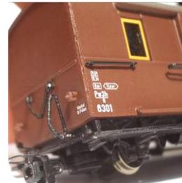
Am hinteren Ende des Wagens, neben den Türen werden noch zwei weitere waagrechte Griffstangen (EHE1005) montiert. Diese unterscheiden sich von den senkrechten Griffen am vorderen Ende durch eine kleine „Nase“ an einer Seite.
