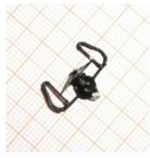
Bei allen dreiachsigen Güterwagen der MzB müssen die Bremsschläuche (ZDT1037) an der Stirn und Hinterseite der Wagen in die dafür vorgesehenen Löcher geklebt werden (Cyanacrylatkleber). Die Weißmetallteile werden werkseitig lackiert. Die gerippten Schläuche sollten vor der Montage noch weiß lackiert werden. Verwenden Sie einen kleinen Pinsel und dünnflüssigen Lack!
