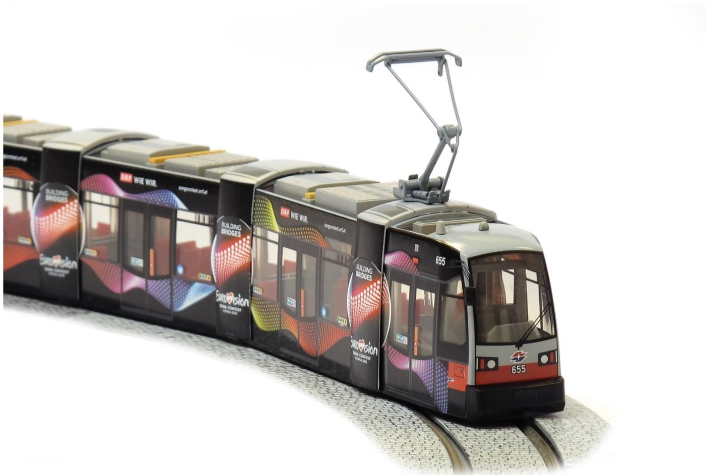
Der ULF (Abkürzung für Ultra Low Floor, englisch für „Niedrigstflur“) ist ein Niederflur-Straßenbahnfahrzeug, das von Siemens Rail Systems für die Wiener Linien entwickelt wurde. Der ULF zeichnet sich durch seine achsfreien Fahrwerke und eine der niedrigsten Einstiegshöhen weltweit bei Straßenbahnen aus. Für Wien wurden in den Jahren 1994 bis 2017 insgesamt 330 Züge des Typs ULF gebaut.
