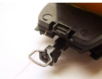
Die Leiter der Stromaufnahmen werden mit den Lötstellen an den Flügeln der Platine verlötet. Die Orientierung ist egal. Bei Kondensator müssen Sie natürlich auf die Einbaurichtung achten (Brandgefahr!). Wir auf dem Foto ersichtlich muss die Minusseite (-) an der äußeren Lötstelle an der Platinenunterseite verlötet werden.
