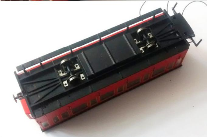
Die Kabel werden unter den Sitzen nach hinten verlegt und verlötet. Die Achsen werden wieder eingesetzt, wobei darauf zu achten ist, dass die Schleifer die Radscheiben nur sanft berühren und nicht blockieren. Der Wasserkasten muss noch etwas angepasst werden und wird an der Wagenunterseite angeklebt
